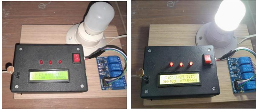
**Gambar 13.** Modul ESP-8266 Kiri Kondisi Mati dan Kanan Kondisi Hidup
