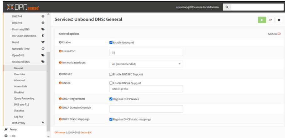
**Gambar 3.** Konfigurasi Unbound DNS
