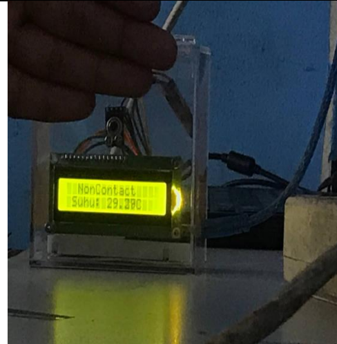
Gambar 4.4 Sampling Pengukuran di Ruang Ber-AC dengan jarak objek 15 cm, objek berupa tangan manusia
