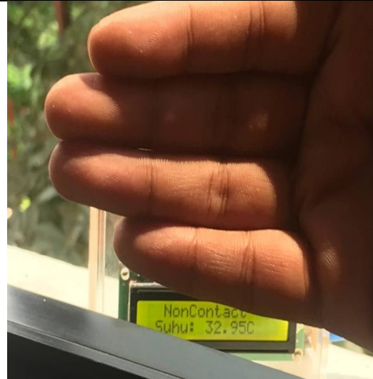
Gambar 4.8 Sampling Pengukuran di Ruang Terbuka dengan jarak objek 15 cm, objek berupa tangan manusia.
