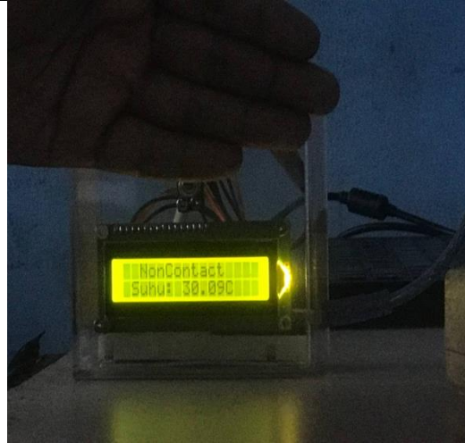
Gambar 4.2 Sampling Pengukuran di Ruang Ber-AC dengan jarak objek 5 cm, objek berupa tangan manusia
