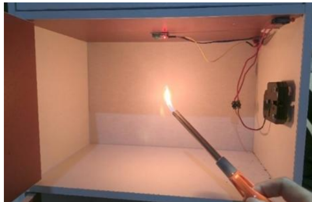
Gambar 12. Proses Pengujian Sensor DHT 11
