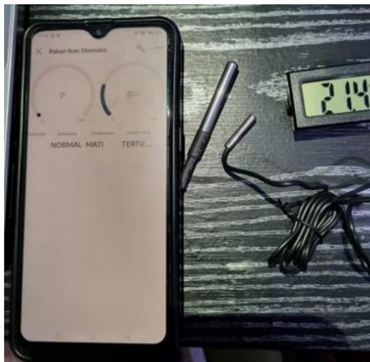
**Gambar 4.** Pengujian Sensor Suhu DS18B20
