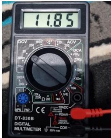
**Gambar 5.** Uji kipas DC menggunakan multimeter saat HIGH
