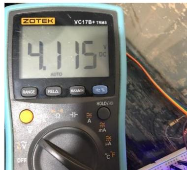
**Gambar 9.** Pengukuran Dari Kaki Kolektor Ke Basis
