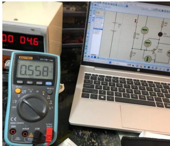
**Gambar 17.** Pengukuran Kaki Emitor Ke Kolektor
