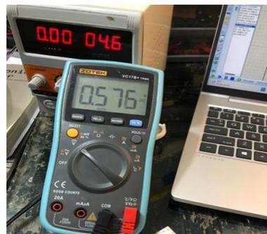
**Gambar 11.** Pengukuran Kolektor Ke Emitor Mencari Tegangan Input
