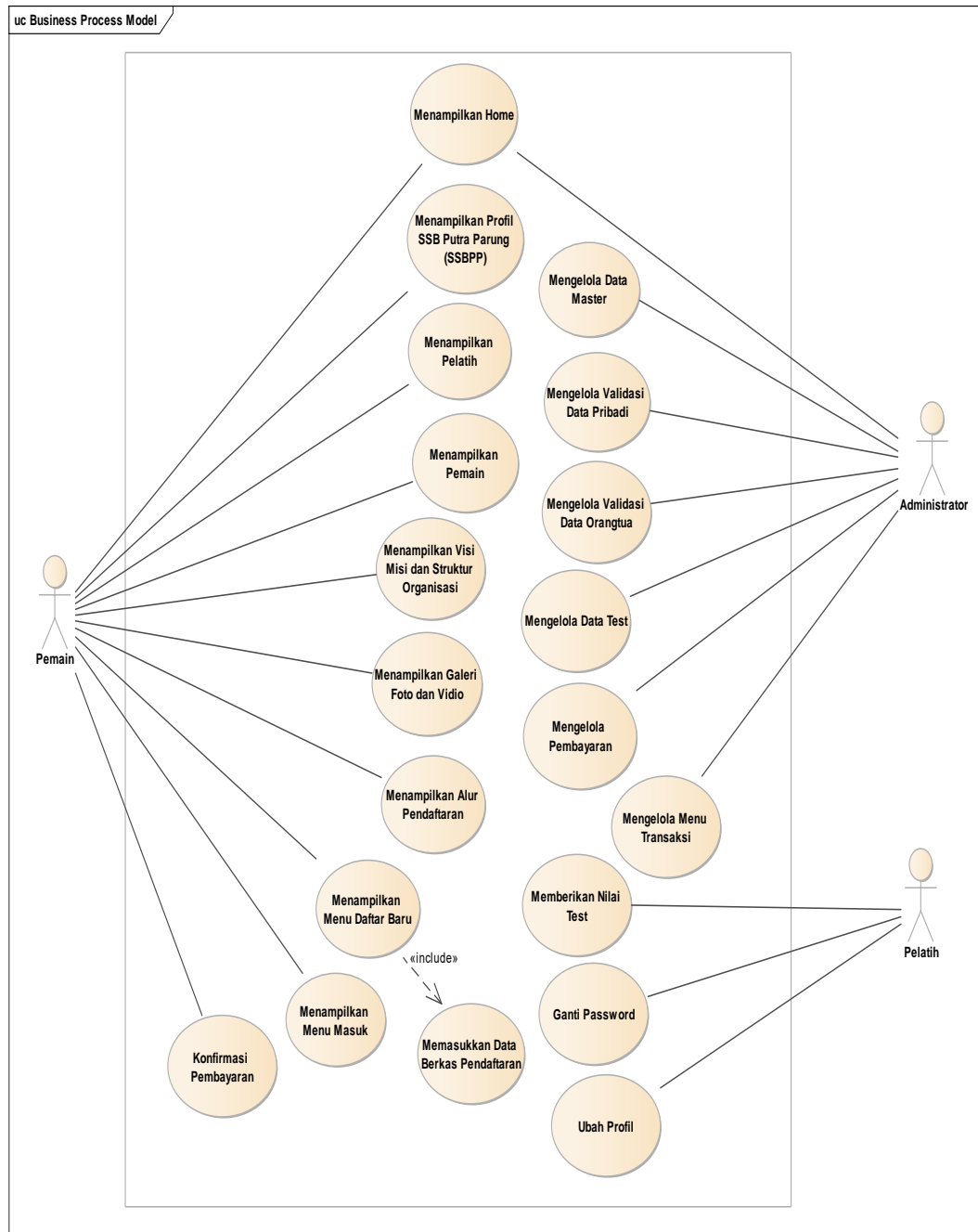
Gambar 3. Use Case Diagram Sistem Informasi Pendaftaran Siswa Baru Pada Sekolah Sepak Bola Putra Parung
