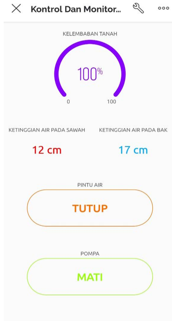
Gambar 6. Sistem Menu Pengendalian Blynk IoT
