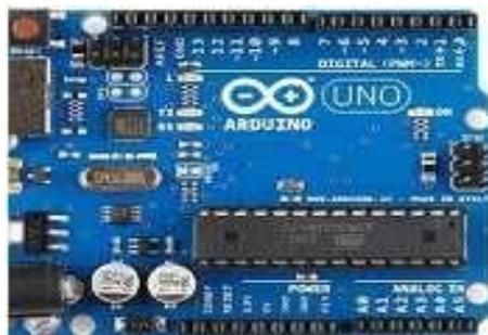
**Gambar 1.** Bentuk Fisik Arduino Uno
