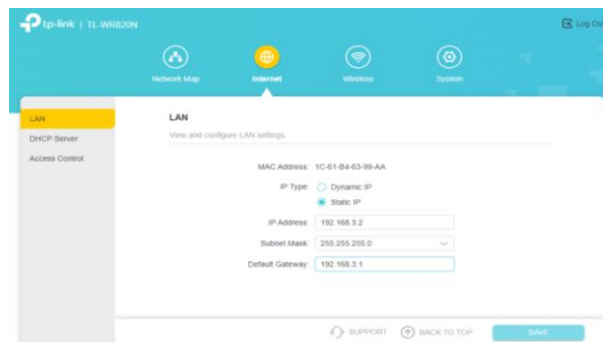
Gambar 24. Pemberian IP Adres Pada Access Point
