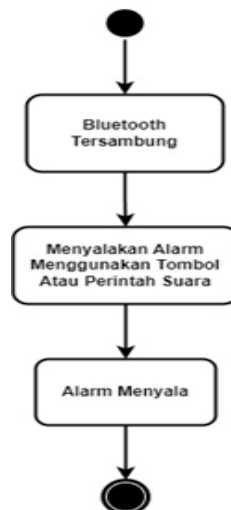
Gambar 15. Activity Diagram Menyalakan Alarm Sepeda Motor
