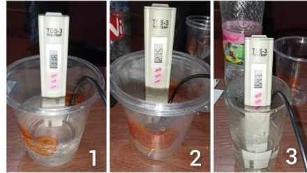
Gambar 10. Sampel air pengukuran suhu dengan alat manual dan sensor DS18B20 (kabel hitam)
