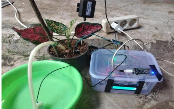
**Gambar 14.** Alat Saat Melakukan Penyiraman
