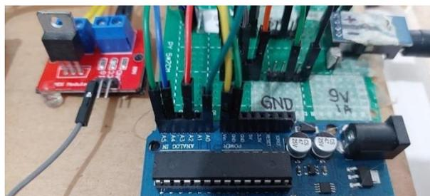
**Gambar 6.** Rangkaian Arduino dan Sensor Ketinggian Air
