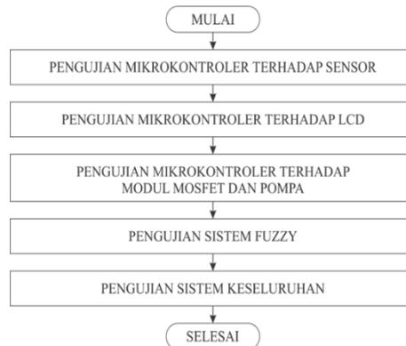
**Gambar 4.** Diagram Pengujian Sistem
