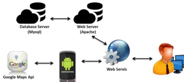
Gambar 4. Blok Diagram Aliran Data dari Database ke Android dan Admin
