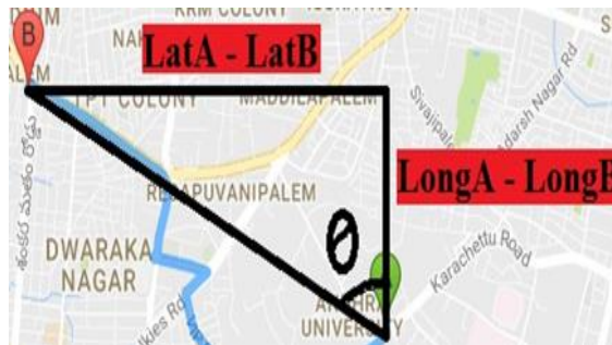
Gambar 4. Mencari Derajat Putar Menggunakan Trigonometri
