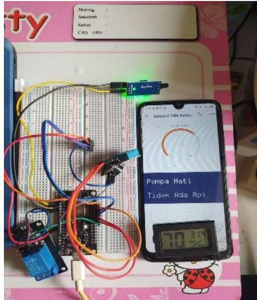
**Gambar 7.** Pengujian Sensor DHT11 Menggunakan Thermometer
