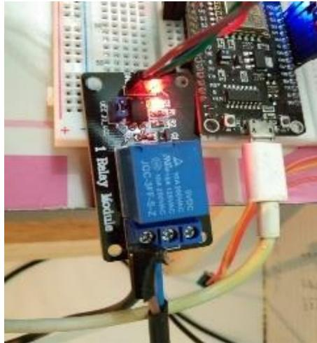
Gambar 8. Pengujian Relay 1 Channel ON
