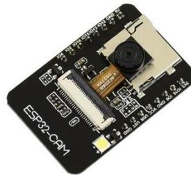
**Gambar 2.** *ESP32 CAM*
