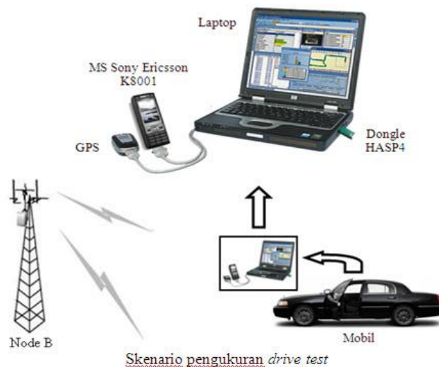
Gambar 1. Metode Pengukuran Drive Test
