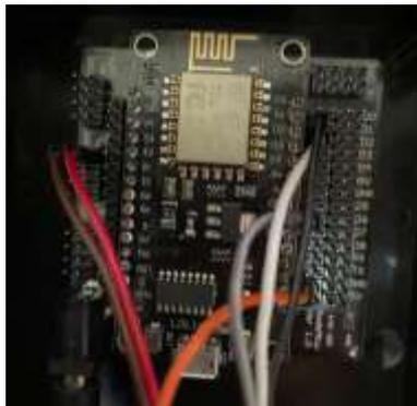
**Gambar 2.** NodeMCU ESP8266 dan *Step Down*
