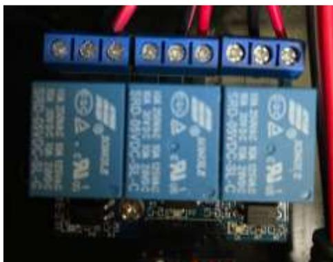
**Gambar 3.** Relay 3 *Channel* Yang Sudah Dihubungkan Dengan Nodemcu ESP8266
