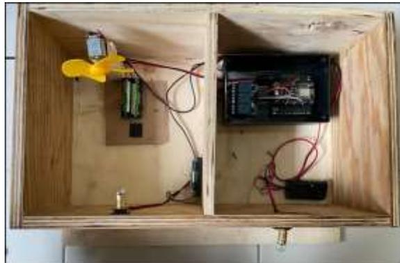
**Gambar 1.** Rangkaian *Prototype Smart Home* berbasis *Internet of Things* via Telegram Bot menggunakan NodeMCU ESP8266
