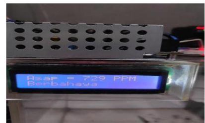
Gambar 11 LCD status diatas 300 ppm Berbahaya Fan menyala 4
