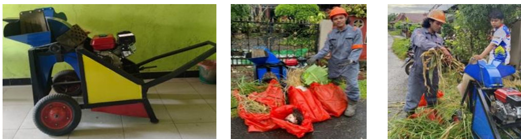
Gambar 7. Proses Pengujian Mesin Pencacah Limbah Pertanian
