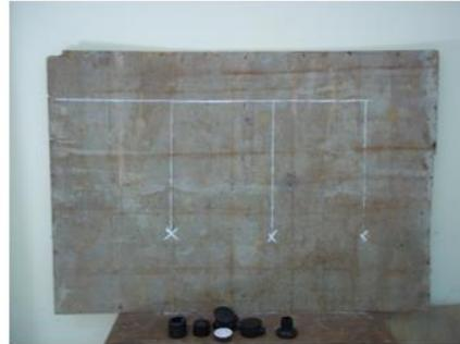
Papan tripleks untuk model sederhana rangkaian instalasi listrik.
