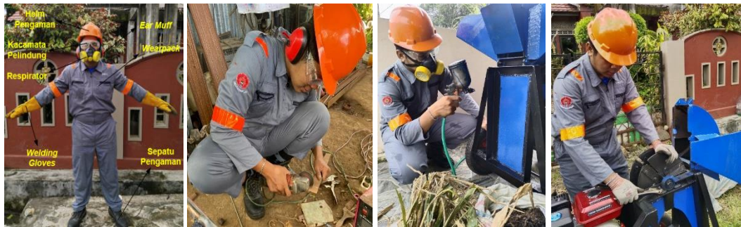
Gambar 4. Perlengkapan APD dan Proses Pembuatan juga Perakitan Mesin Pencacah Limbah Pertanian
