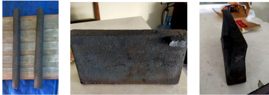
Gambar 9. Hasil Cor Sampel Uji Tarik
