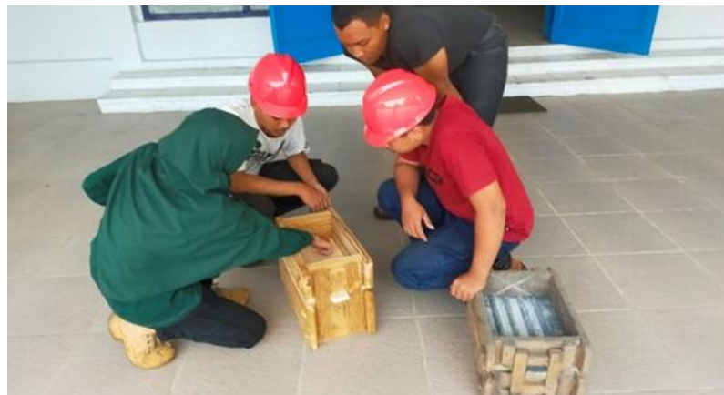
Gambar 6. Pengarahan dan Pengecekan Dimensi Cetakan Type Y-Test
