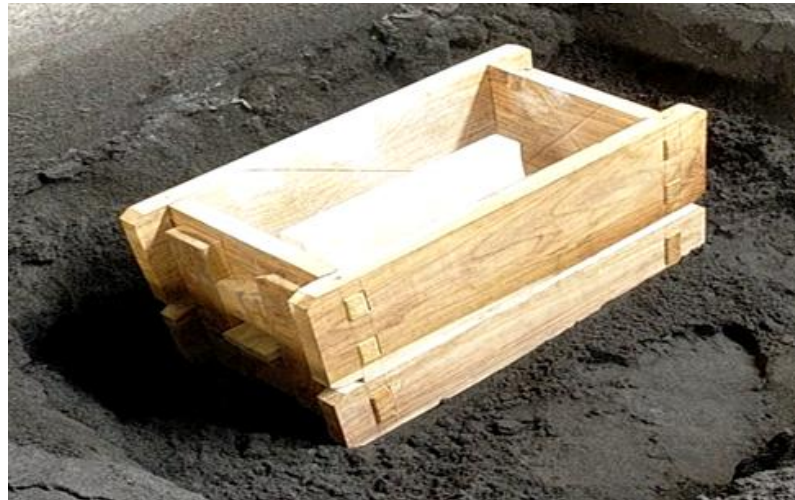
Gambar 5. Hasil Penguatan Cetakan Type Y-Test Sample
