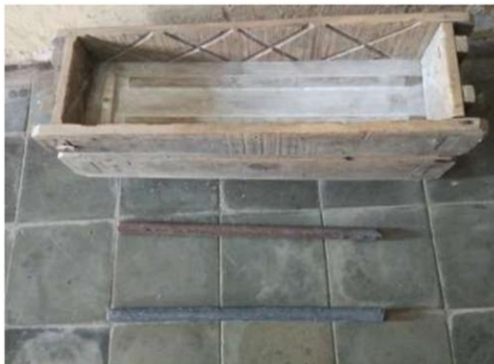
Gambar 1. Cetakan dan Batang Uji Tarik yang Saat Ini Dibuat di Industri Pengecoran Logam Ceper Klaten
