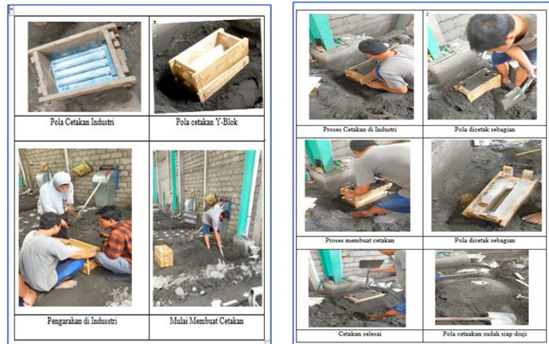
Gambar 7. Tahapan Proses Persiapan Pencetakan Pola Untuk Proses Peleburan
