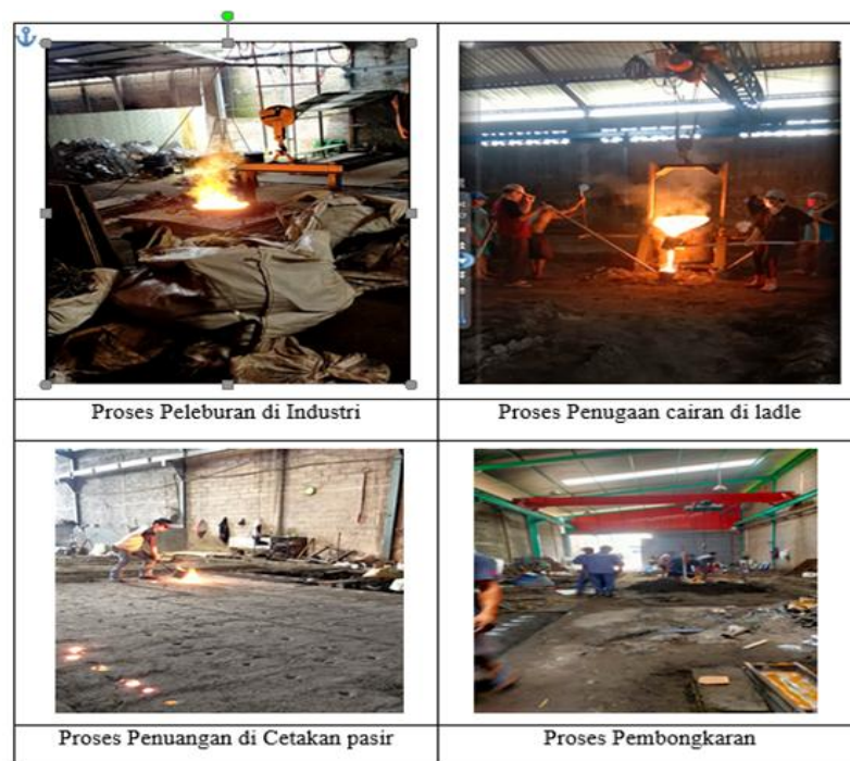
Gambar 8. Tahapan Proses Peleburan Logam
