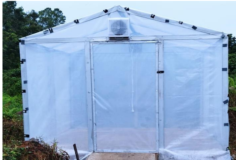
Gambar 4. Rumah pengering sederhana keripik tortilla rumput laut
