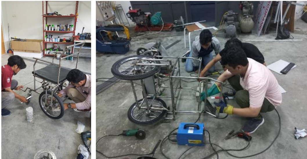
Gambar 4. Proses perakitan rangka kursi roda
