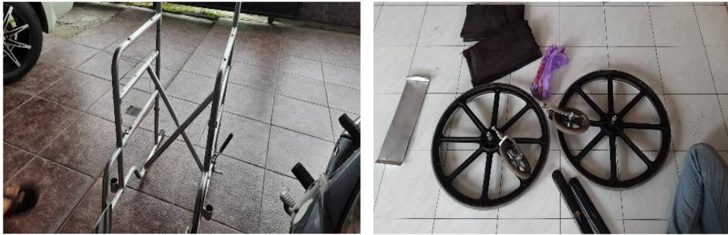
Gambar 3. Rangka Kursi Roda Elektrik Hasil Rancangan
