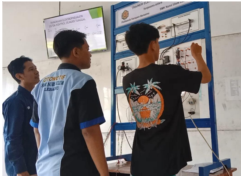
Gambar 9. Peserta pelatihan mempraktikkan pemasangan kabel pada trainer Elektro Pneumatik
