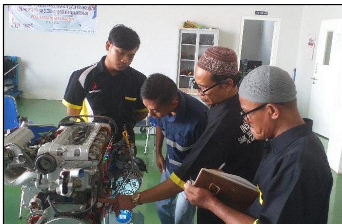
Gambar 3. Identifikasi Electronic Control Unit (ECU) , sensor, dan actuator di engine berteknologi EFI
