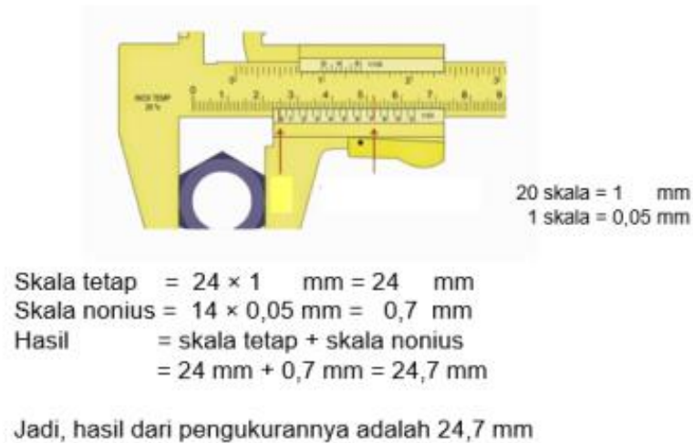
Gambar 3. Pembacaan Skala Jangka Sorong
