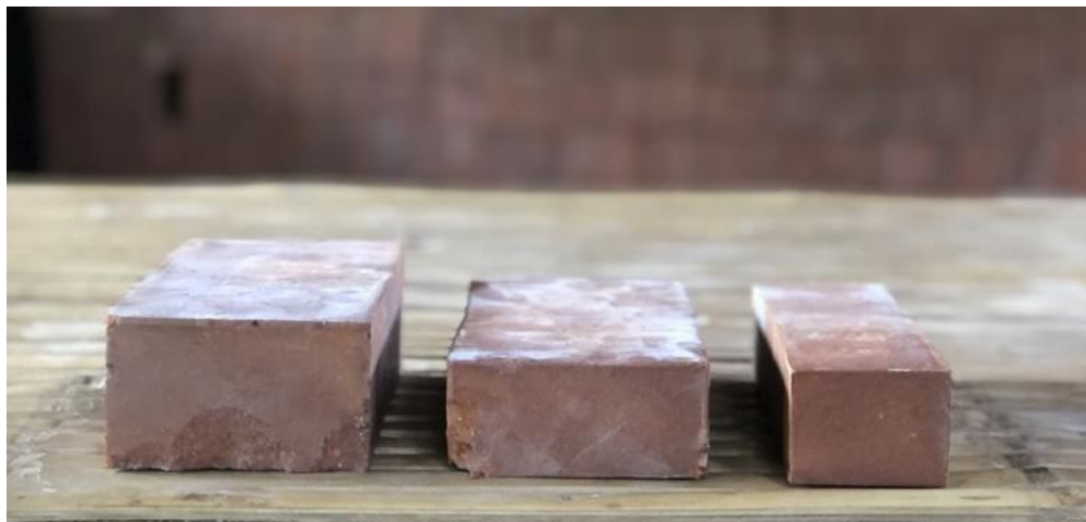
Gambar 1. Produk bata press produksi UD. Intan Dari kanan ke kiri: bata tipis panjang, bata tipis dan bata tebal Sumber: Dokumentasi pribadi
