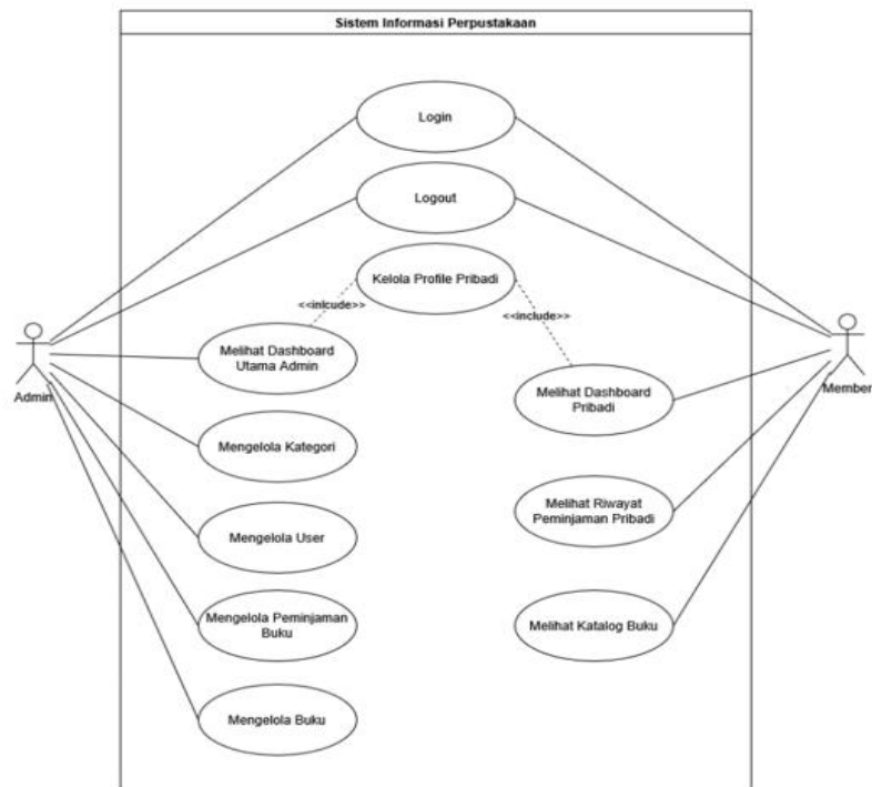
Gambar 1. Use Case Diagram Sistem Informasi Perpustakaan
