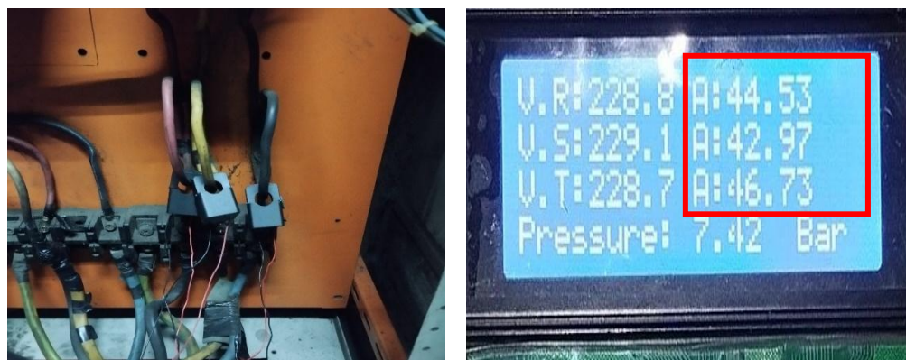
Gambar 10. Pengujian Sensor CT PZEM-004T
