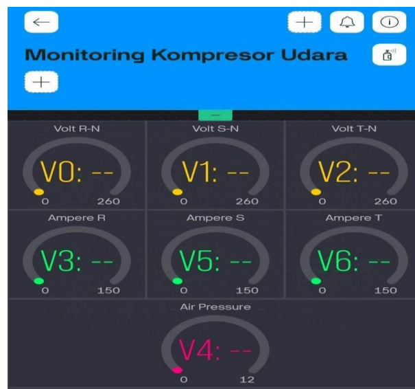
Gambar 6. Tampilan Sistem Monitoring Aplikasi Blynk
