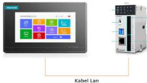
Gambar 3. Jalur komunikasi PLC dan HMI
