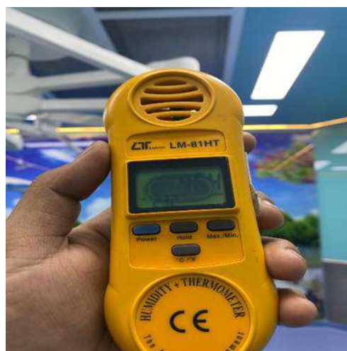
Gambar 23. Pengujian Dengan Sensor LM-81HT
