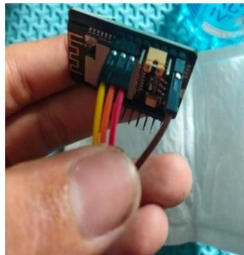
**Gambar 12.** Pemasangan kabel ke ESP32-CAM
