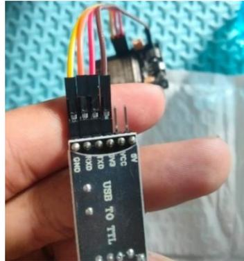
**Gambar 11.** Pemasangan Kabel Ke USB TTL
