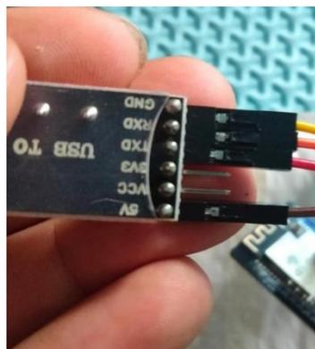
**Gambar 13.** Perubahan Susunan Kabel ESP32-CAM
